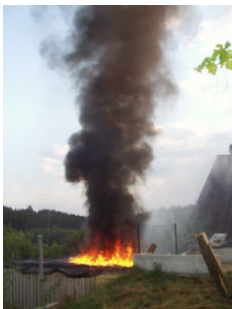
Image 17: La membrane se consume sur l'isolant
