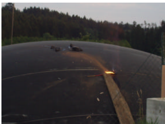
Image 9: 5. Test de feu avec une torche : fuite de biogaz par le trou fait par la combustion de la torche; un chiffon enflammé est utilisé pour être sûr que le gaz prend bien feu.
